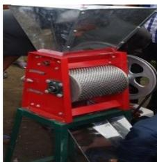
Gambar 7. Mesin Pengupas Kopi Basah
